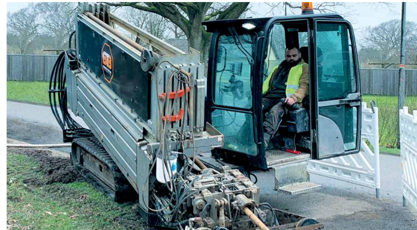
Der GRUNDODRILL 15XP bei der Pilotbohrung.
